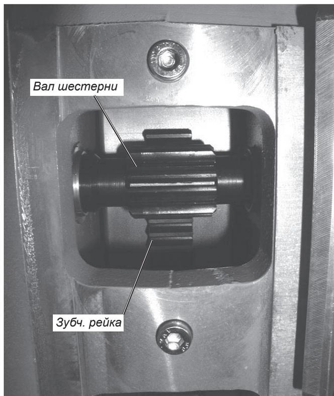
Салазки Р-6000 на колонне (Вид со стороны фланца крепления мотора).
