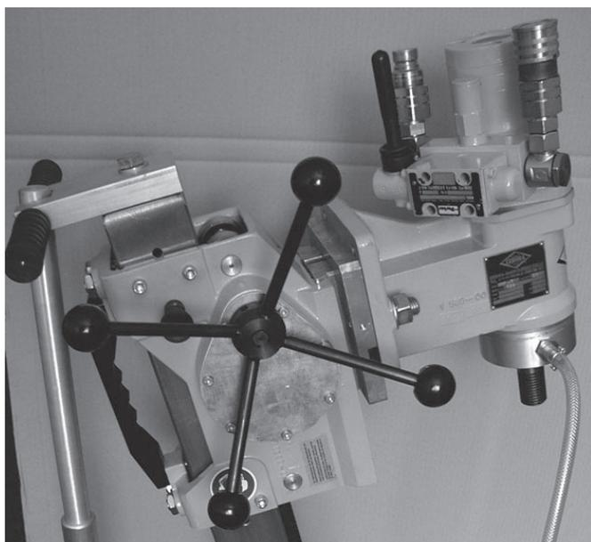
Гидромотор HM-161 с BSP-3 смонтирован на пластину для BSP-3 и на салазки P-6000 Рис. 3.40
