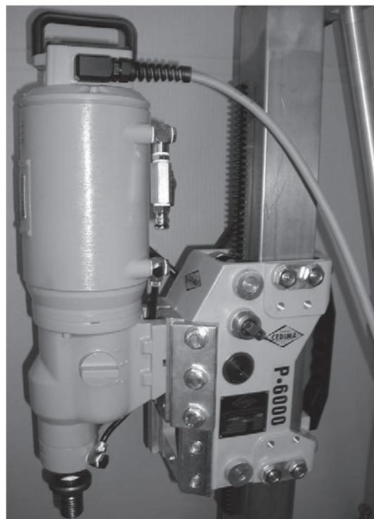
Мотор (EM-3/7) смонтирован в верхнем положении на салазках P-6000
