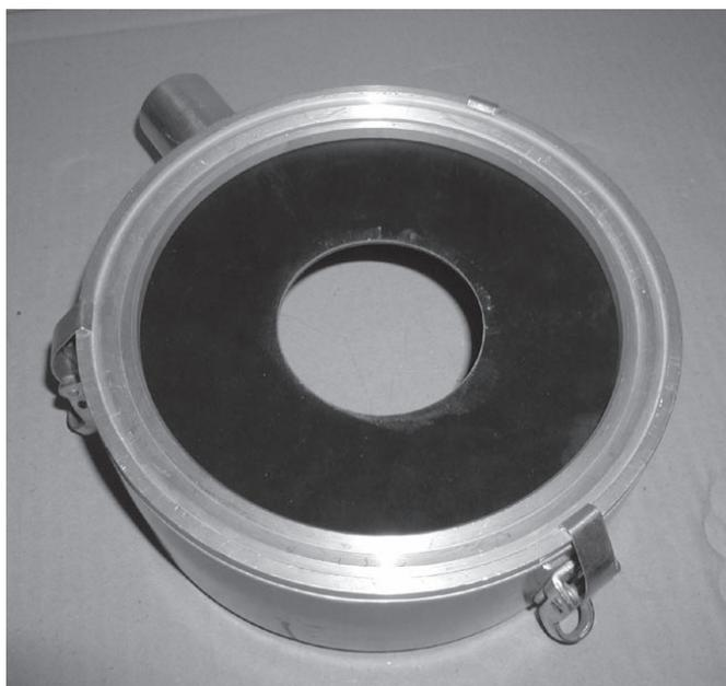
Водосборное кольцо в наложенном уплотн. кольцом (для коронки Ø 81 мм) и зажатой крышкой (-кольцом) Рис.3.47
