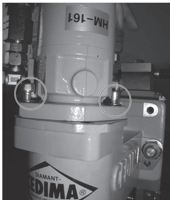
Гидромотор HM-161 на шпindel BSP-3 и на салазке P-6000 смонтирован
