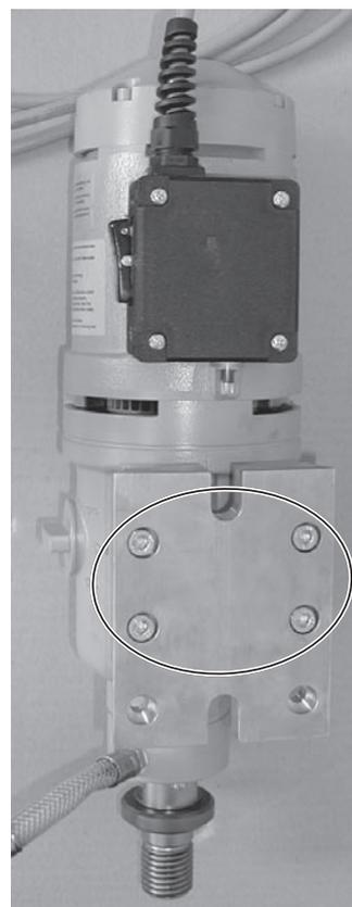
Мотор EM-3/4, со смонтированной пластиной тип С, (поз. 1) для высокой выемки
