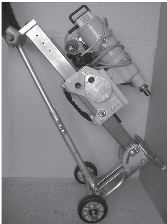
Транспортировка сверильной системы Р-6000 (с мотором, и доп. опорой) Рис. 5.3
