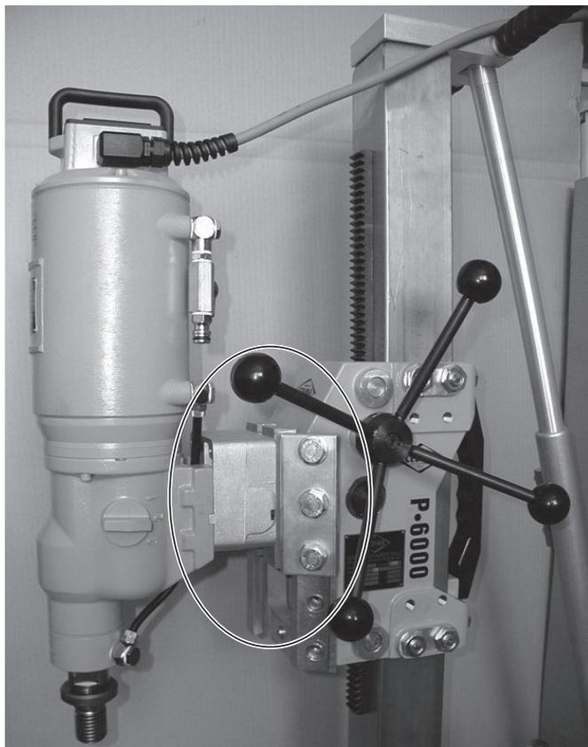
Мотор (EM-3/7) с (60 мм) дистанц. плитой и пластиной тип С на салазках P-6000 смонтирован Рис. 3.33
