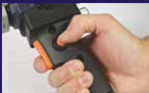
Кнопка-фиксатор для постоянной сварки с меньшими усилиями
