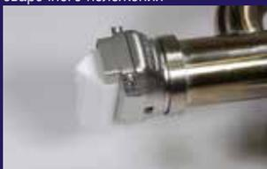
Быстросменные сварочные башмаки с вращением на 360° обеспечивают высокую производительность
