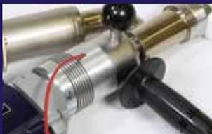
Простая вставка сварочного прутка с обеих сторон для удобного контроля сварочного положения
