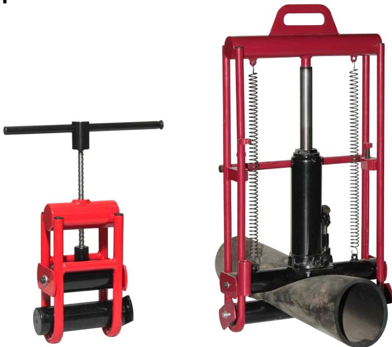
Предназначен для временного пережатия трубы ПЭ до 225 мм. Оснащен домкратом силой 12 тонн. Стопорные замки исключают потерю давления в закрытом состоянии.
