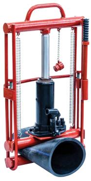
Предназначен для временного пережатия трубы ПЭ до 225 мм. Оснащен домкратом силой 12 тонн. Стопорные замки исключают потерю давления в закрытом состоянии.
