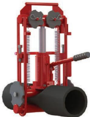
Процесс передавливания следует проводить медленно.
