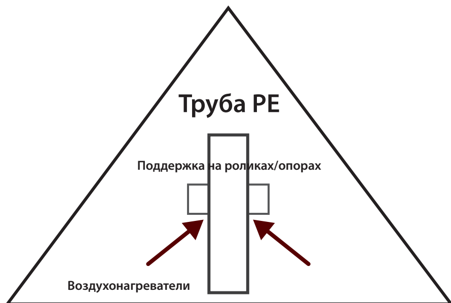
Рисунок 1 – Схема подогрева трубы
