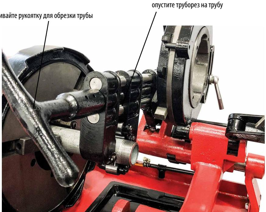
Не скапливайте обрезки труб в поддоне. Удаляйте их непосредственно после завершения процесса обрезки трубы и остановки электродвигателя станка.
