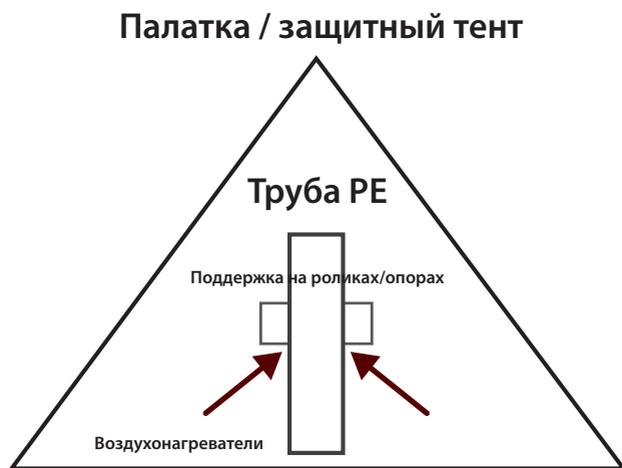
Рисунок 1 – Схема подогрева трубы
